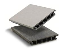
La surface de la lame Optima Eko est une peau en PVC coextrudée et poncée. Le PVC rend la lame totalement hermétique, et la finition poncée permet la bonne adhérence du platelage. En contrepartie, le ponçage peut provoquer une fine rétention d'eau localisée sur certains secteurs du platelage. Les avantages de la lame :
