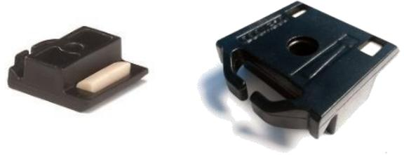
Clip breveté Optima pour lames de terrasse Optima, Optima Plus et Optima Eko d'Océwood®. Développé pour faciliter la pose des lames, le clip Optima est asymétrique et bloque la lame lors de sa dilatation tout en absorbant celle-ci. Poser dans le sens de la flèche indiquée sur le clip.
